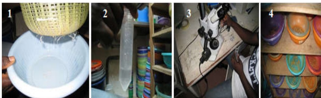
Légende : (1) : Passoire, (2) Eprouvette contenant le nématode, (3) Comptage du nématode au Binoculaire, (4) Processus d'extraction du nématodes
