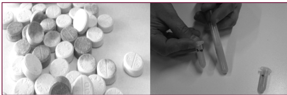
Figure 16.2. Analyse visuelle de comprimés de paracétamol défectueux (photo de gauche) et de suspensions d'amoxicilline reconstituées dans l'eau (photo de droite). La suspension défectueuse se trouve dans le tube long et les suspensions de référence dans les petits tubes.
