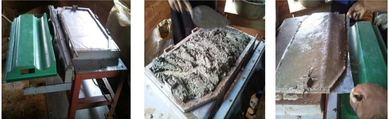
**Figure 5 :** *Photos des moules, de la table vibrante et des tuiles d'expérimentation.*
