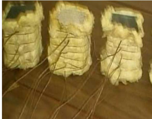
Figure 2 : Photo des éprouvettes isolées avec de la laine de verre.
